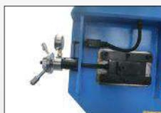
Tensão hidromecânica da lâmina
