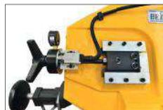
Tensão hidromecânica da lâmina
