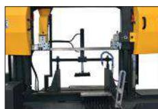
Fixação superior hidráulica
