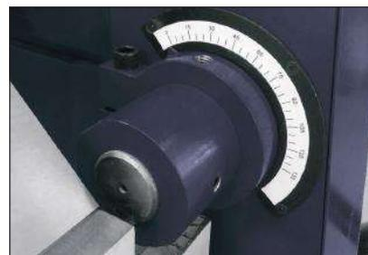
Ângulo de flexão ajustável manualmente por escala
