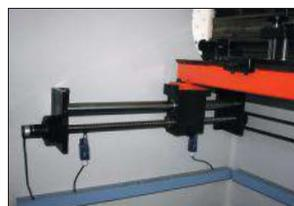
Guiamento Linear de esferas temperadas / Eixo Servo-Motorizado (esbarro traseiro)
