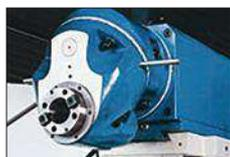
Pode fresar qualquer superfície angular através de meia esfera frontal girando a cabeça de fresagem.
