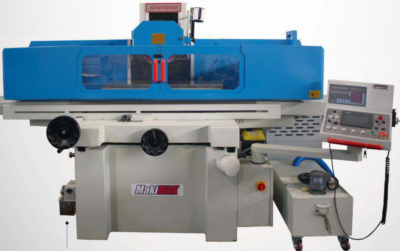
Sistema de lubrificação central automático
