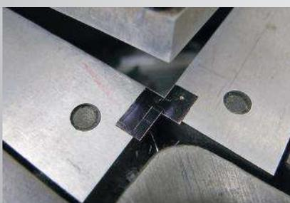
Este modelo mecânico é projetado para trabalhos leves a médios. É usado em trabalhos com materiais de até 2 mm de espessura. É usado em dobradiças de alumínio, canais de ar condicionado, painéis publicitários e capas de chapa metálica.
