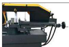
Fixação hidráulica do torno horizontal
