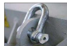
Manilha de auxílio para alternar entre operação horizontal e vertical
