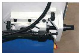
Ajuste de tensão da lâmina
