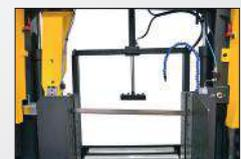
Fixação superior hidráulica
