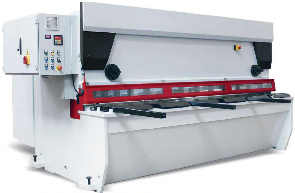
A gama de guilhotinas hidráulicas com inclinação de lâmina e corte NC, realizam cortes em comprimento de 3 e 4m e de espessura de chapa (450Nm) entre 6 e 10mm.
