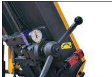
Tensor hidráulico da lâmina
