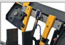
Sensor de ajuste de altura
