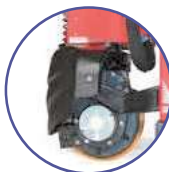
Motor tracción 0,65 kW Rueda Ø210x70mm
